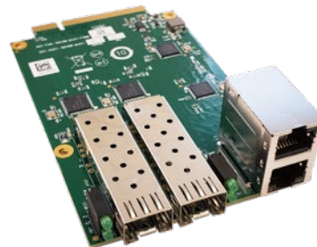
Network Module NM0 (1G SFP, 1G RJ-45)
